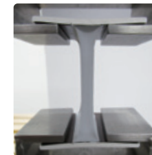
引張接着試験 (樹脂材※)
